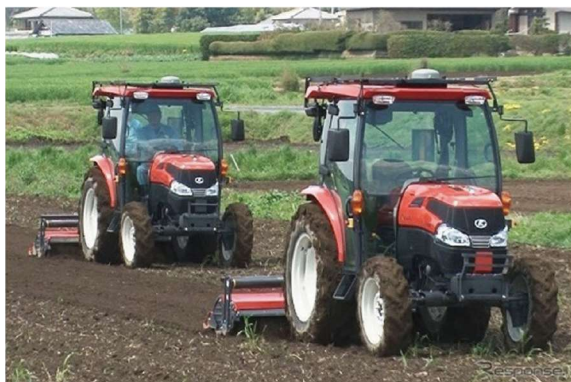
図 1-2 無人で自動運転が可能なロボットトラクタ（前）
