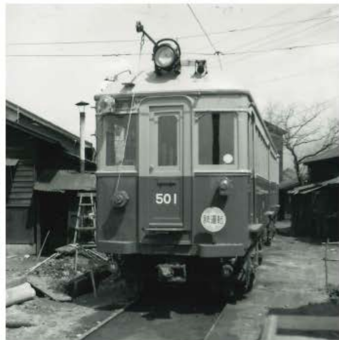
昭和48年頃のデナ501。元は「阪神839」だった。阪神電鉄在籍時はパンタグラフで集電していたが、叡山電車ではポール集電になった。
