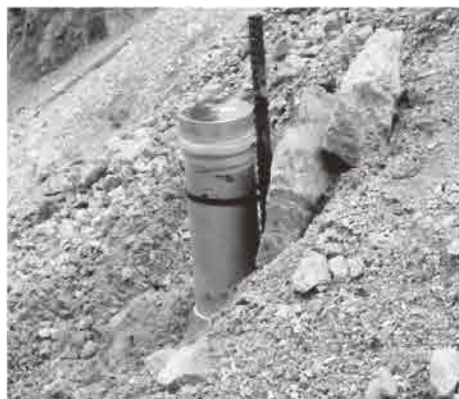
図 38-1 斜面崩壊検知センサ（転倒検知タイプ）の例
