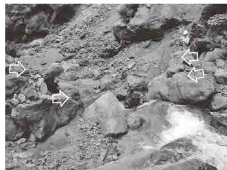
図 38-2 土石流ワイヤセンサの設置例
